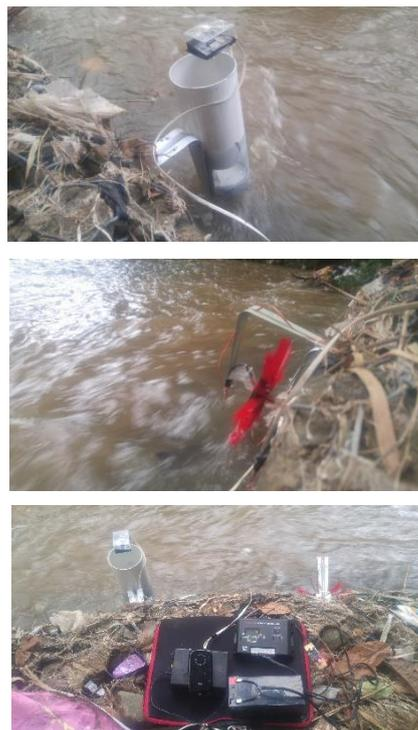
Gambar 11. Sensor Ultrasonic (a), Sensor *IR Line Tracking* (b), dan Keseluruhan Perangkat (c). Sumber: Dokumen Pribadi (2023)
