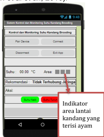
Gambar 2. Aplikasi pengontrol dan monitoring suhu berbasis mobile
